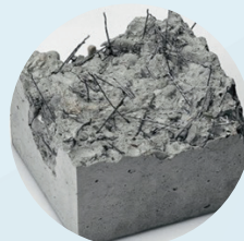
Faserbeton Stahlanteil: 2,5 - 3,2 kg/m 2
